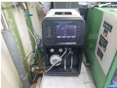
ภาพที่ 2.2-4 การติดตั้ง CO Analyzer บริเวณเตาหลอม
