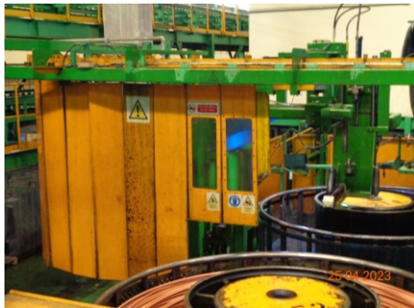
ภาพที่ 2.2-28 การปิดครอบเครื่องจักรที่มีเสียงดังเพื่อลดระดับเสียง
